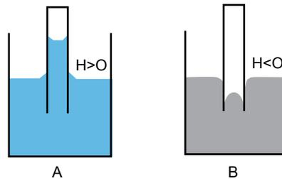
**Figura 2.** Explicación de la capilaridad: A) el líquido sube por el tubo ( $H > 0$ ) porque el ángulo es menor a  $90^\circ$ ; B) el líquido baja ligeramente ( $H < 0$ ) porque el ángulo es mayor a  $90^\circ$ .
