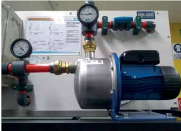
**Figura 39.** Bombas centrífugas.
