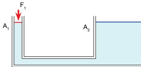
**Figura 4.** Principio de Pascal: el cambio de presión en alguna parte del fluido confinado introduce el mismo cambio de presión en todas las partes del fluido.  $p_1 = p_2$ .
