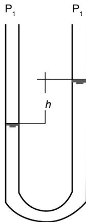
**Figura 6.** Manómetro diferencial o en U.  $P_1 - P_2 = (\gamma_g - \gamma_f) \cdot h$ . Donde  $\gamma_g$  es el peso específico del fluido transportado, que siempre es menor al del fluido manométrico.
