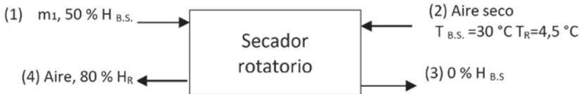
*Grados de libertad.* Incógnitas: cuatro corrientes. Las composiciones no son conocidas directamente, pero no se requieren ecuaciones de balance para hallarlas, por lo tanto, no se consideran incógnitas en principio. Ecuaciones de balance: tres: material seco, agua y aire seco. No hay ecuaciones adicionales. G.L.=4-3=1. Se requiere una base de cálculo. Puede tomarse 1 kg de material húmedo en la corriente que vamos a numerar como (1).
